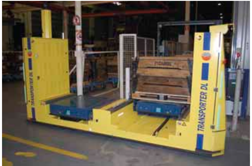
Bij Picanol lopen zes nieuwe tandem-AGV's proef in de montage. Elke Double Load Transporter telt twee shuttles die links of rechts aan de automatische magazijnen volle pallets oppikken om er daarna de lege pallets weer af zetten.
